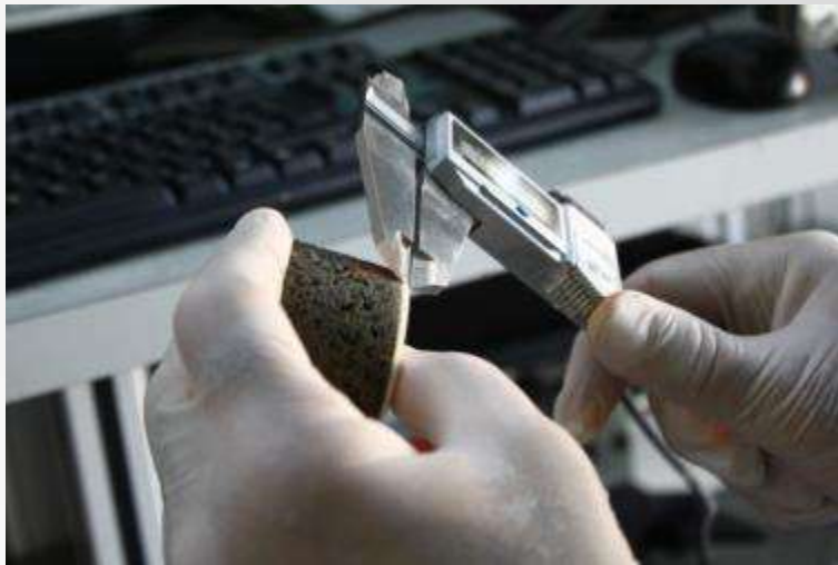
Medição de revestimento de pavimento (Previstos 3mm de espessura).
