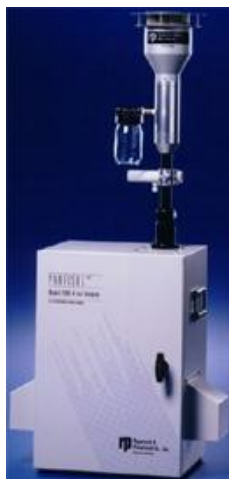
Figura 10: Amostrador de partículas atmosféricas em suspensão ( Partisol Plus 2025 )
