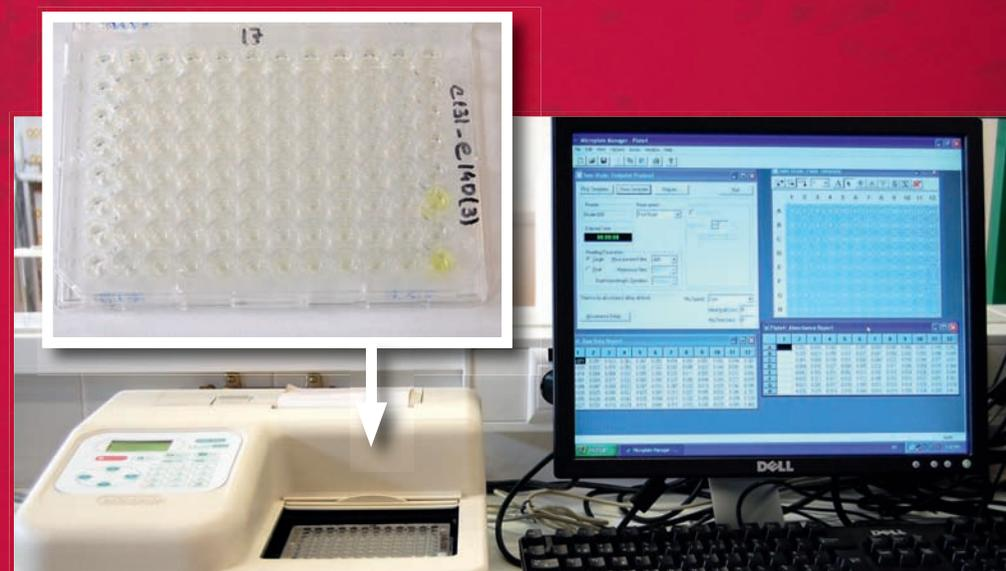
Figura 6 – Placa utilizada no teste ELISA e equipamento para a leitura dos resultados.
