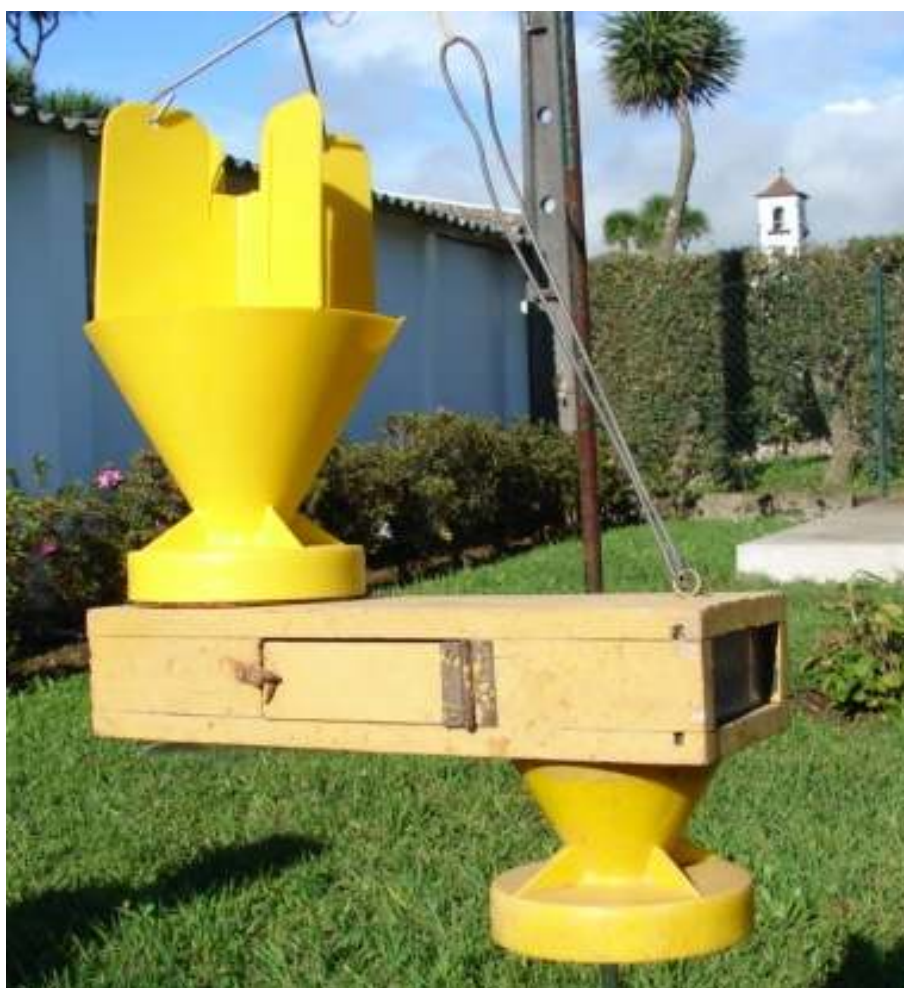
Figura 12 – Armadilha do tipo Ellisco modificada para utilização da técnica de autodisseminação do fungo Metarhizium anisopliae .
