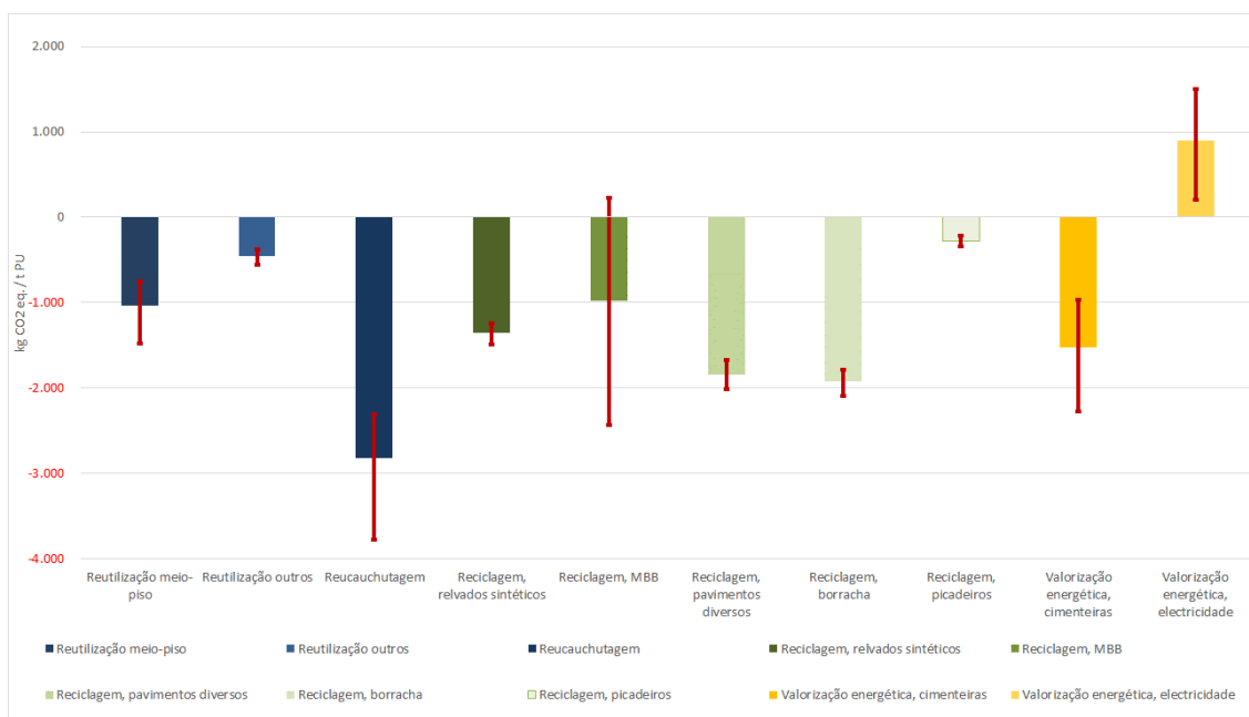
Figura 31 – Comparação directa e análise de incerteza do benefício ambiental de várias operações de reutilização e valorização de pneus usados e aplicações do granulado de borracha no SGPU para a categoria de alterações climáticas (por tonelada de pneus usados processados em cada operação, 2011)
